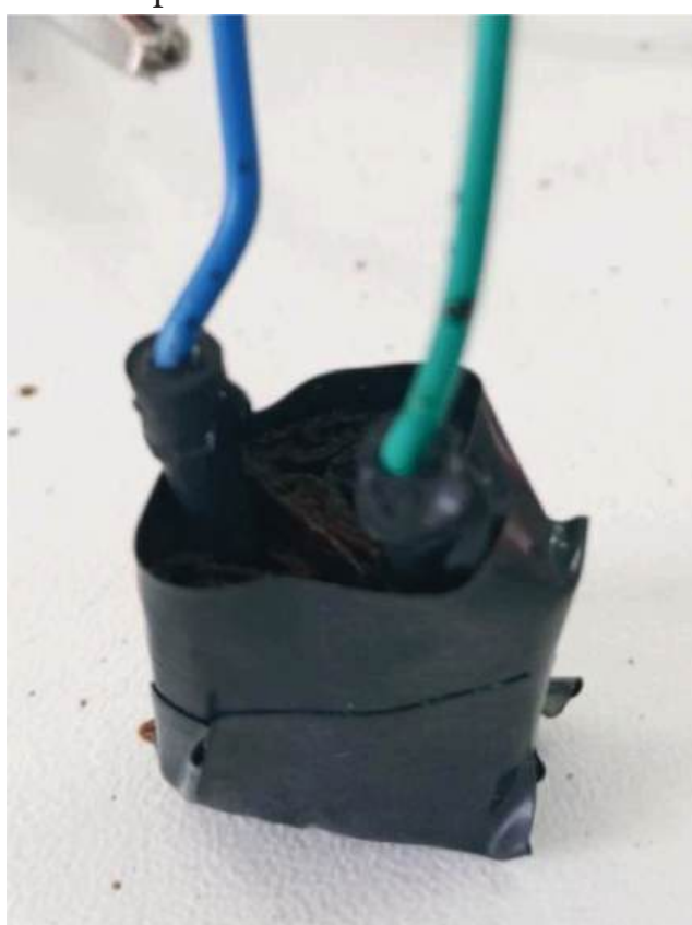
Figura 4 - supercapacitor enrolado com o auxílio de uma espátula e envolto em fita isolante
