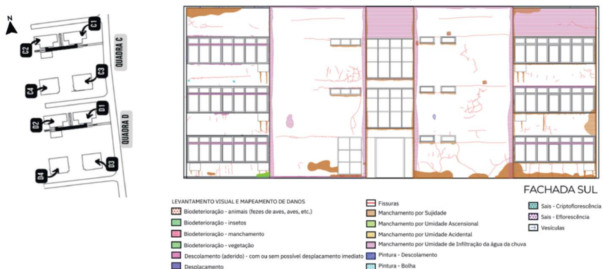
Figura 1 - Localização das edificações e mapeamento de danos com suas respectivas legendas, levantados pelo software AutoCAD 2D, exemplificando as patologias encontradas
