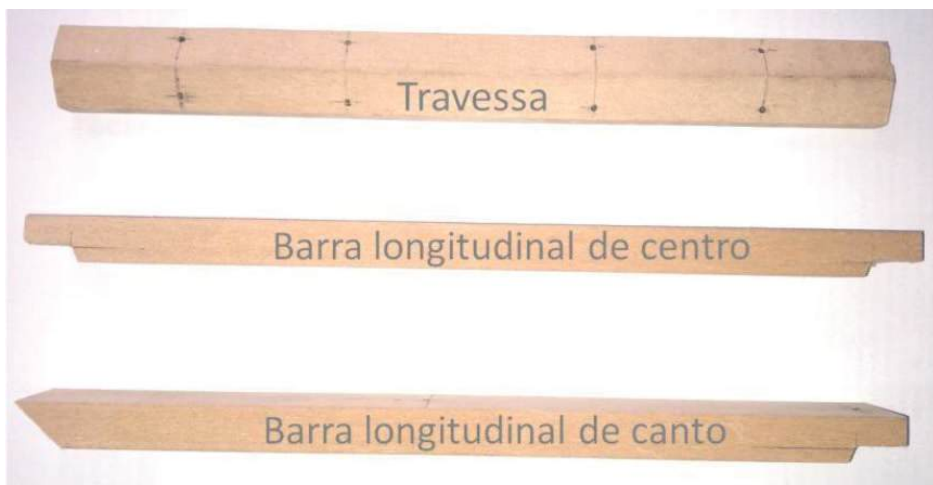
Figura 3 – Barras da ponte após corte e furação
