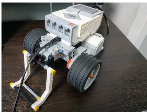
Figura 4 – Um exemplo de Robô criado puramente com o kit Lego Mindstorms Ev3 Fonte: Javier Leiva
